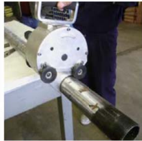
アタッチメント (オプション) により、 配管曲面にも適用可
